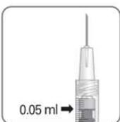
8. Vorsichtig die Luft zusammen mit der überschüssigen Lösung aus der Spritze herausdrücken und die Dosierung auf die 0,05-ml-Markierung der Spritze einstellen. Die Spritze ist nun fertig zur Injektion.
